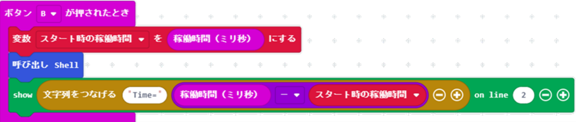
図3 内部タイマーを使ったソートの稼働時間の計算方法とその表示プログラム
